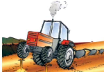
Figura 1: Vuelco hacia atrás se da en condiciones de altos esfuerzos de tiro, la barra de tiro larga y alta favorece este tipo de accidente.
